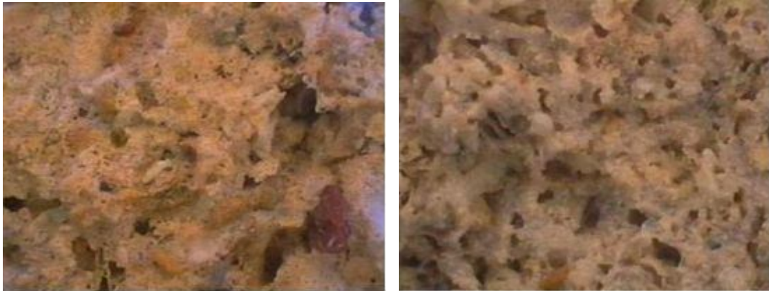
Εικόνα από μικροσκόπιο οπτικών ινών. Πρόκειται για πωρόλιθο από τη μεσαιωνική πόλη της Ρόδου α. πριν και β. μετά τη στερέωση, διαγνωστική μελέτη του ΕΜΠ.
